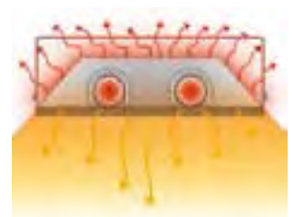
Wärmestrahler ohne Dämmung: Die Reflektorbleche erreichen Temperaturen über 120 °C. Die Wärmeenergie geht nach oben verloren.
